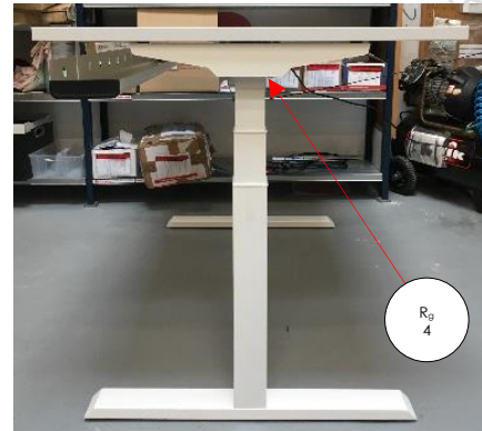
Figura 3 y 4. Detalle de las posiciones a las cuales se realizaron los ensayos de resistencia superficial ( R_s ) y resistencia a tierra ( R_g ).
