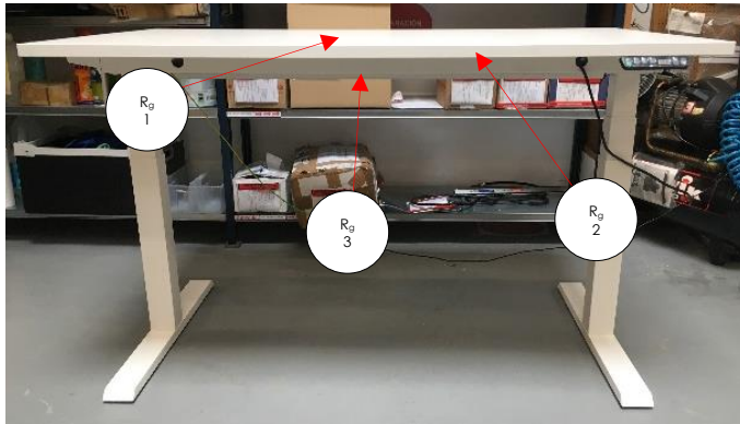
Figura 3 y 4. Detalle de las posiciones a las cuales se realizaron los ensayos de resistencia superficial ( R_s ) y resistencia a tierra ( R_g ).
